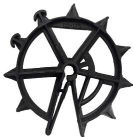
Separador lateral fuerte y ligero. Diseñado para mantener el acero de refuerzo al centro y lograr los recubrimientos de concreto uniformes en ambos lados.
